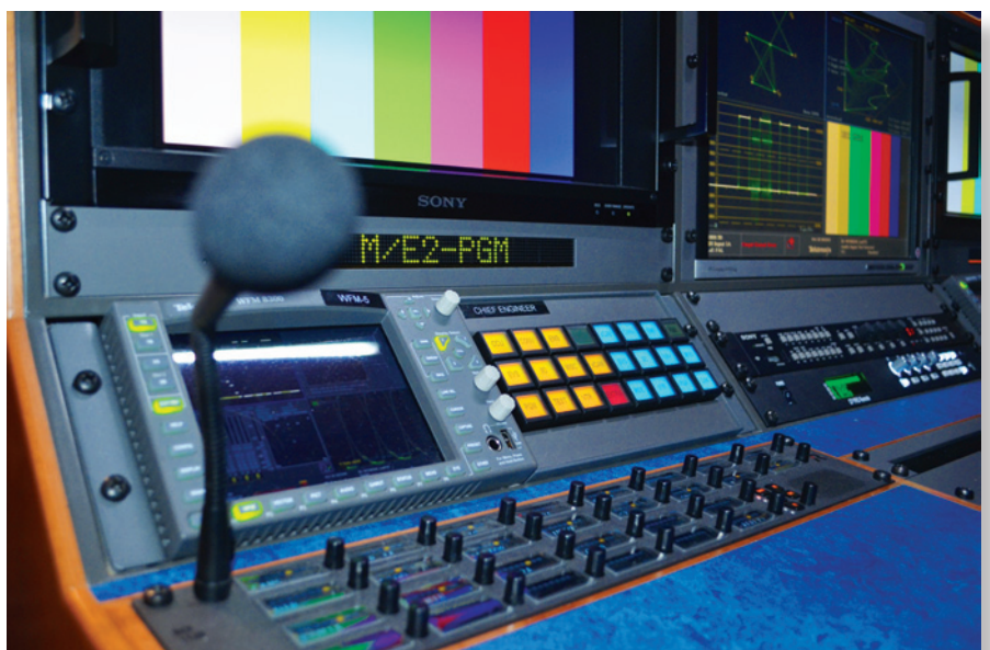
OLED-монитор Sony, прибор Tektronix, консоль управления VSM и панель Riedel Artist на рабочем месте ведущего инженера
